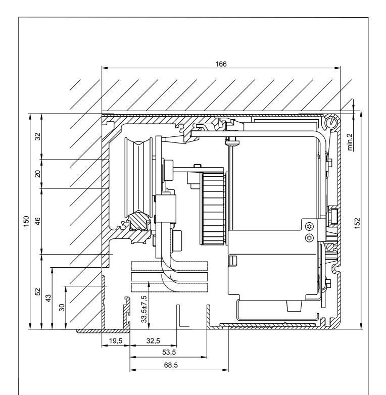
Remplacer le coupe transversale de l'entraînement dans les croquis des dimensions existants (adapter l'hauteur du vantail)
