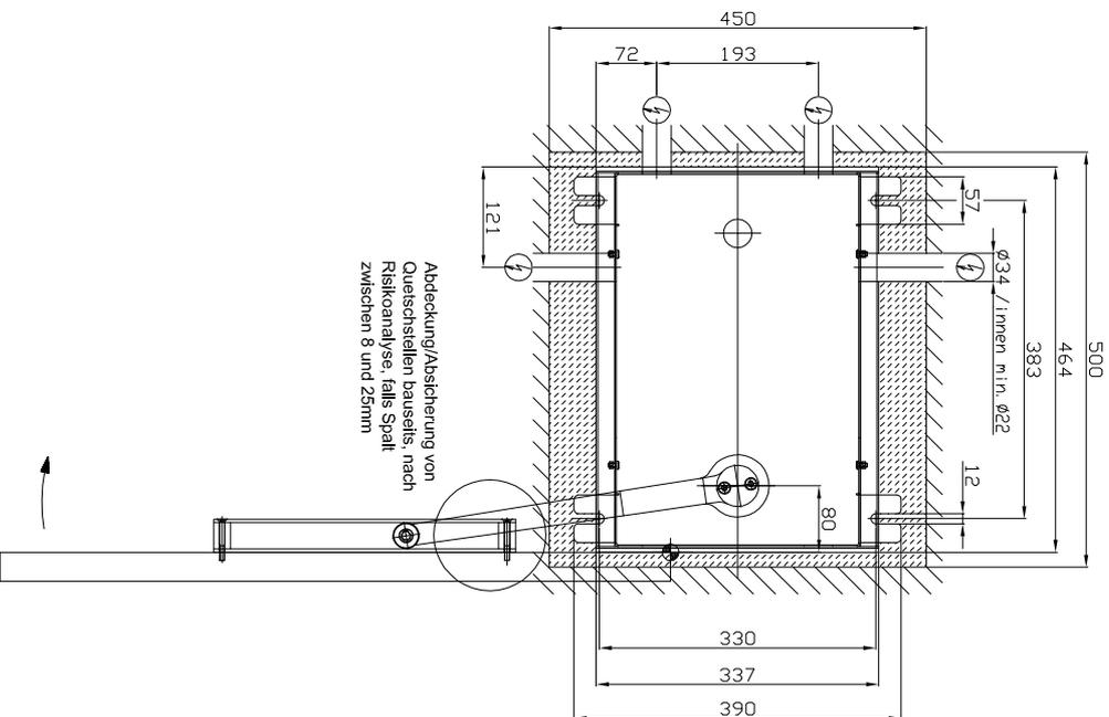
Abdeckung/Absicherung von Querschwellen bauseits, nach Risikoanalyse, falls Spalt zwischen 8 und 25mm
