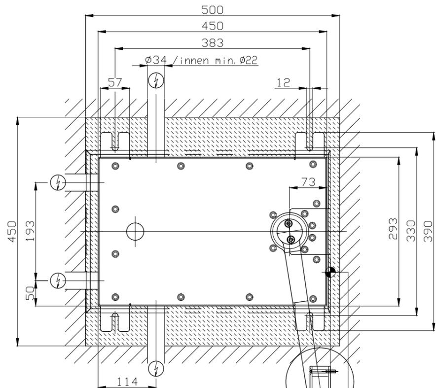
Abdeckung/Absicherung von Quetschstellen bauseits falls Spalt zwischen 8 und 25mm
