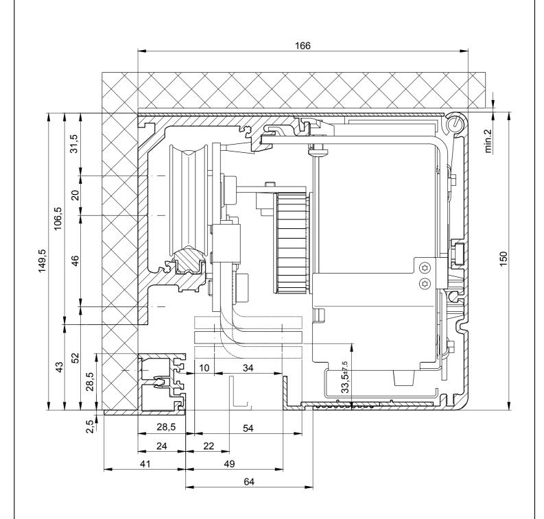
Antriebsquerschnitt in den bestehenden Massbildern ersetzen. (Türflügel anpassen)
